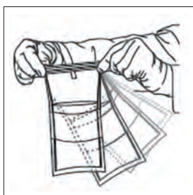
KROK 5A Trzymaj woreczek za uchwyty i zakręć 3 do 4 razy, aby uzyskać uszczelnienie.
